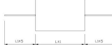
D0引出方式 D0 lead-out method
